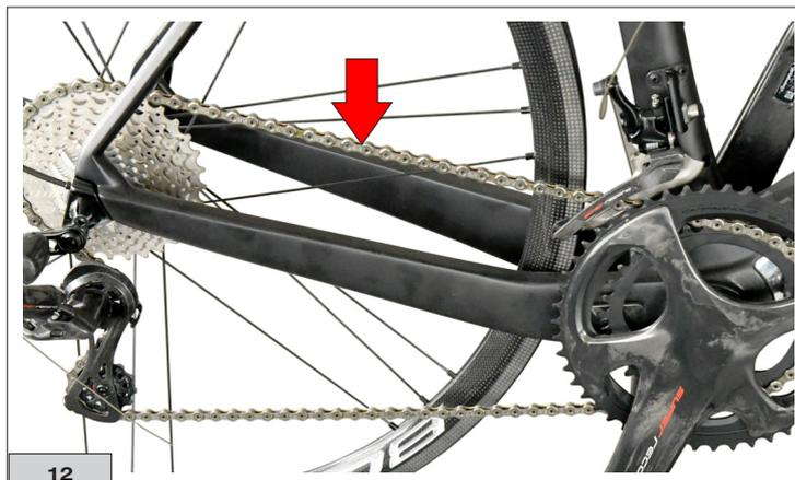
13) Regolate la vite di fine corsa interna, affinché la semi forcella interna sia ad una distanza di 0,5 mm dalla catena (Fig. 13).
