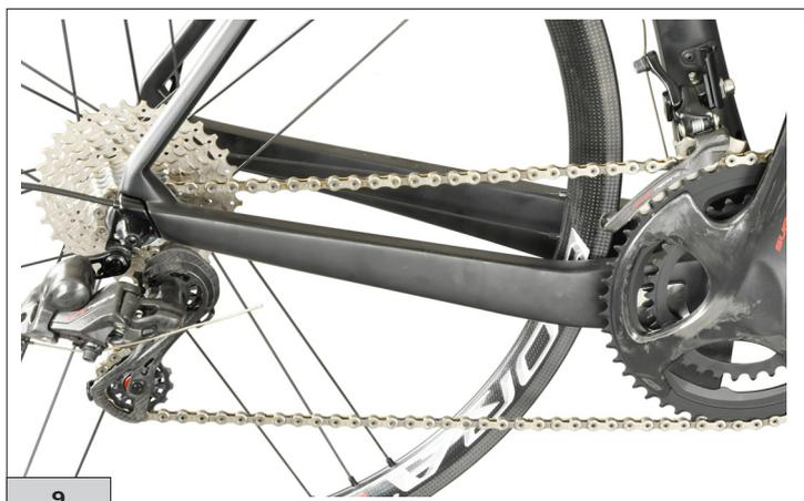
**10)** Agite sulla vite di fine corsa esterna (Fig. 10) in modo che la semi forcella esterna sia ad una distanza di 0,5 mm dalla catena (Fig. 10).
