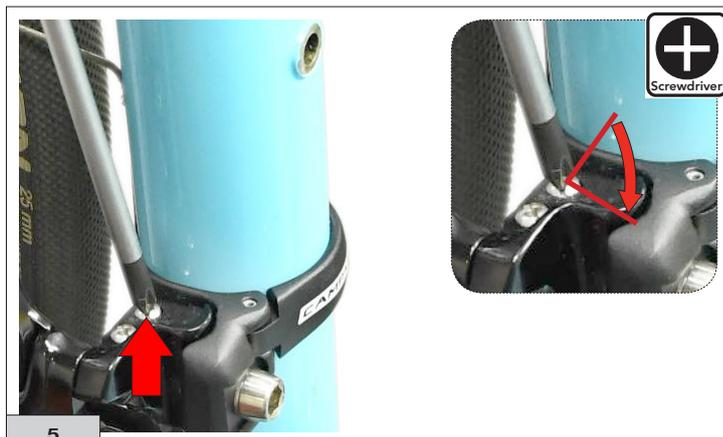
6) Tendete il cavo del deragliatore in modo energico, ed effettuate un primo serraggio (Fig.6).
